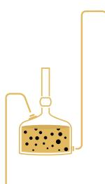
La distillation est une étape importante dans la fabrication. C'est à ce moment-là que l'on obtient la pureté de l'alcool. Le liquide qui provient de la fermentation a plusieurs composants, la chauffe de ce liquide à différents niveaux de température permet de séparer les bonnes des mauvaises vapeurs d'alcool.
